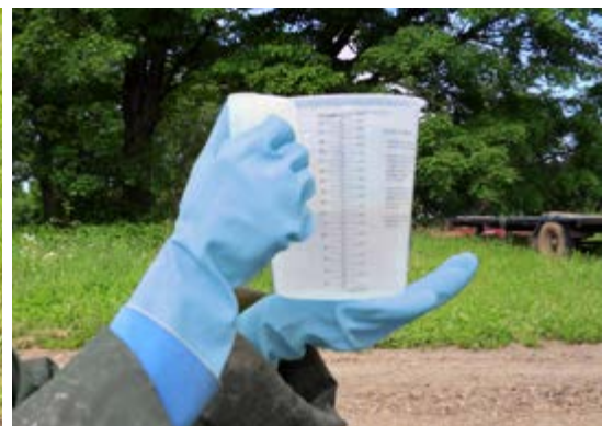
Mesure de la quantité pulvérisée pour chaque buse.
